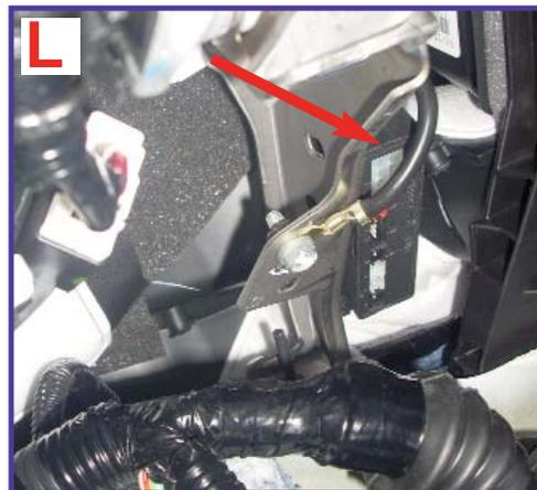
**SEGNALATORE ACUSTICO:** Posizionare il buzzer alla destra della centralina MICU sotto al cruscotto lato guida.
