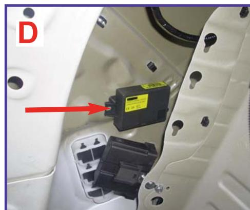
**SEGNALATORE ACUSTICO** : fissare il buzzer dietro la copertura avvolgitore cintura di sicurezza lato guida.
